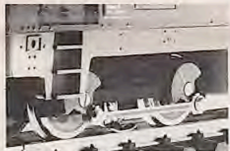
Bild 1 B'B'-Drehgestell der LGB-Lok 2065 mit außenliegenden Gegenkurbeln, den sogenannten Hall'schen Kurbeln mit Kuppelstangen.
