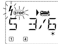
Handelt es sich um einen Kurzschluss, z. B. durch einen entgleisten Waggon oder Zug, beseitigen Sie die Störung.
